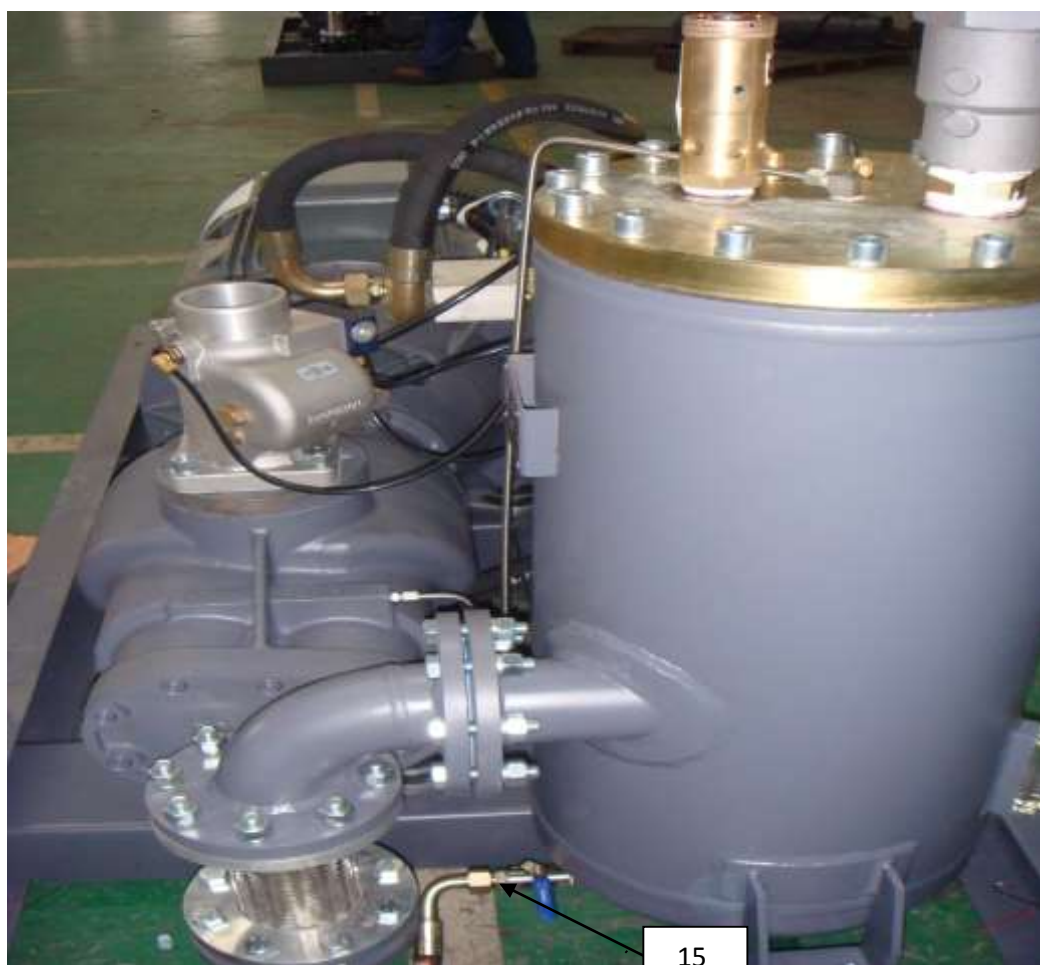
15 - кран слива масла и конденсата (сливной кран).
